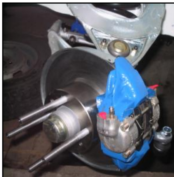
Gyári kerékagy, kiálló menetes szárú tőcsavarokkal
