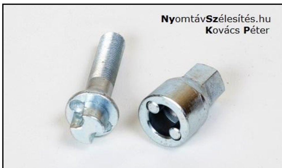
Kerékőr csavar speciális kulccsal
